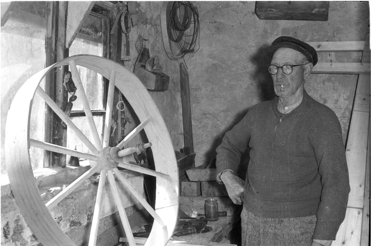
Siúinéir ag déanamh rotha, Inis Oírr, Co. na Gaillimhe (1957) B082.01.00010
